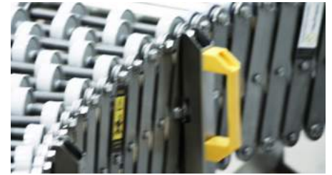
Alças de segurança para movimentação dos transportadores flexíveis.
