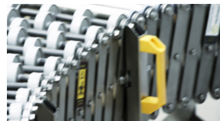
Alças de segurança para movimentação dos transportadores flexíveis.
